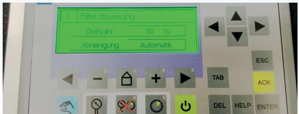
Comando S7 da Siemens integrado
